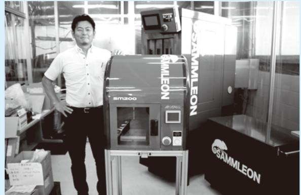
和泉町で自動化生産設備の設計・製作を手掛ける(株)中島精工は、バリ取り工程で悩む部品メーカーのニーズに対応した、卓上バリ取り専用機「SM200」を開発しました。
